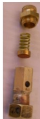
soupape brasée sur un raccord femelle à joint plat
