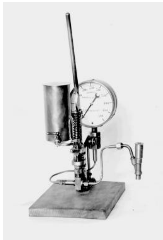
Pompe d'épreuve. Cet équipement sert à évaluer le pouvoir calorifique des carburants. (Archives Sorbonne).
