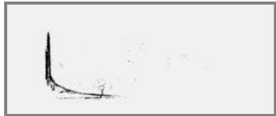
Diagramme montrant la combustion normale du gasoil vaporisé dans le moteur Diesel A. Vernet, 1901. La température figure en ordonnée et le temps en abscisse. (Archives Clerget).
