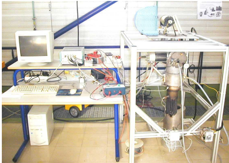
FIG. 2.1 : Vue d'ensemble du moteur, du banc et du système d'acquisition de données
