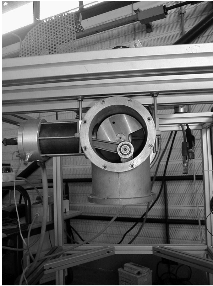
FIG. 2.2 : Partie supérieure, "froide", du moteur ST05G, ouverte et capteurs de p_C et de T_C
