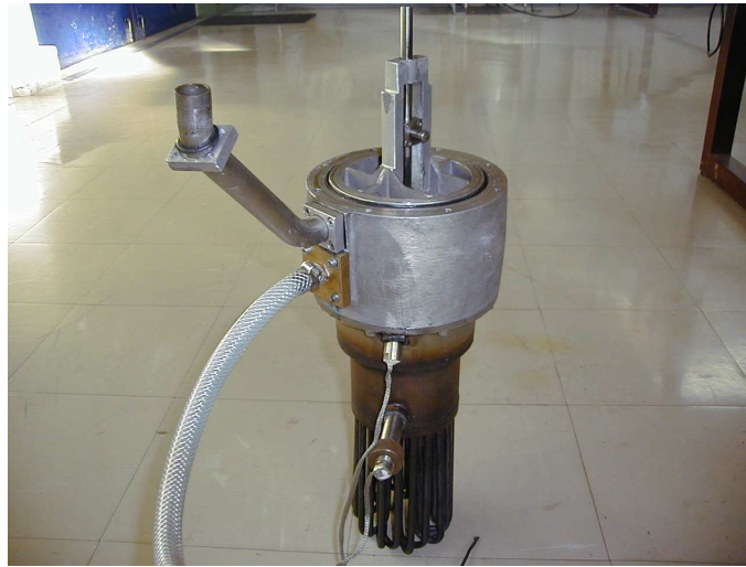
FIG. 2.3 : Partie inférieure, du moteur ST05G, démontée, et capteurs de températures T_{KR} et T_{RH}
